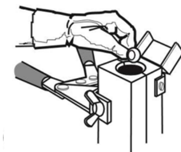
Figura 4: Cerra molde e introducir el disco
