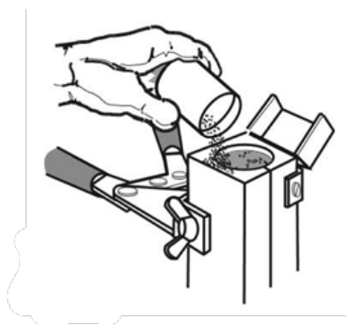
Figura 6: Espolvorear el polvo de ignición sobre la soldadura y depositar aprox. un 25 % sobre el borde del molde
