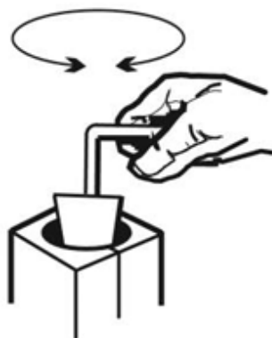
Figura 8: Limpiar con el rascador la escoria de la tolva y de la tobera de colada.
