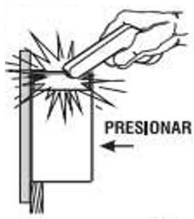
Figura 7: Encender con pistola de ignición (chispero manual)
