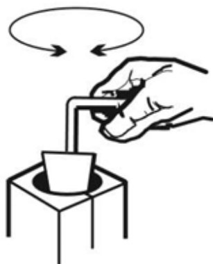
Figura 9: Limpiar con el rascador la escoria de la tolva y de la tobera de colada.
