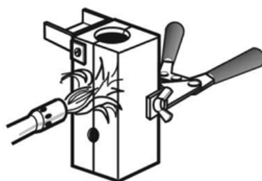
Figura 2: Antes de la primera soldadura, precalentar el molde (5 min aprox)
