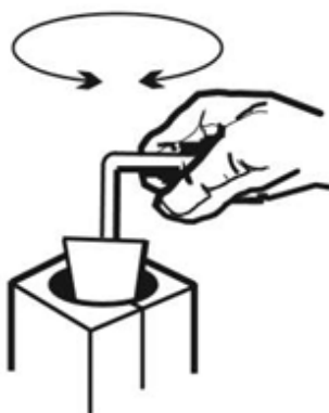
Figura 8: Limpiar con el rascador la escoria de la tolva y de la tobera de colada.
