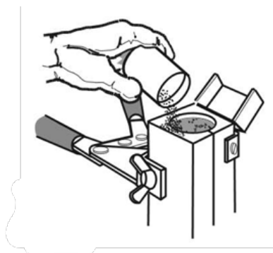
Figura 6: Espolvorear el polvo de ignición sobre la soldadura y depositar aprox. un 25 % sobre el borde del molde
