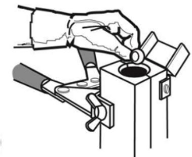
Figura 4: Cerra molde e introducir el disco
